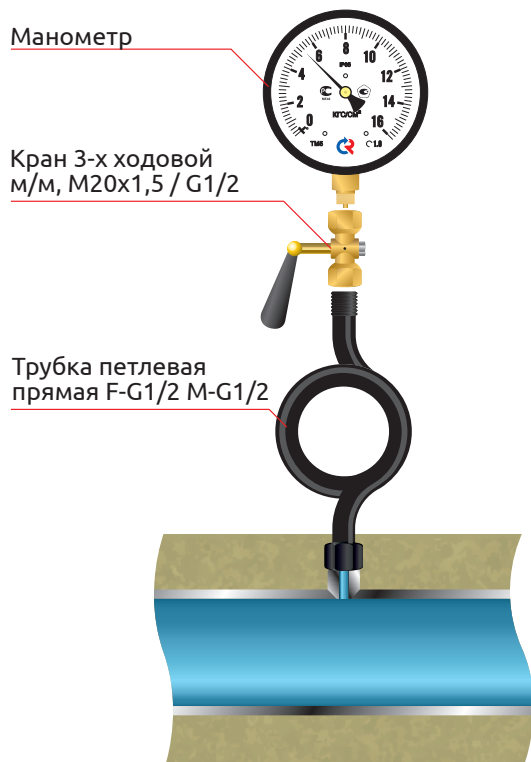
Установка на горизонтальном участке трубопровода
