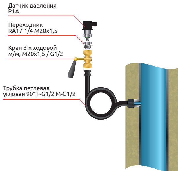
Установка на вертикальном участке трубопровода
