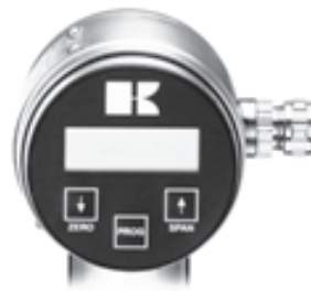
Кнопочная панель с дисплеем для программирования датчика
