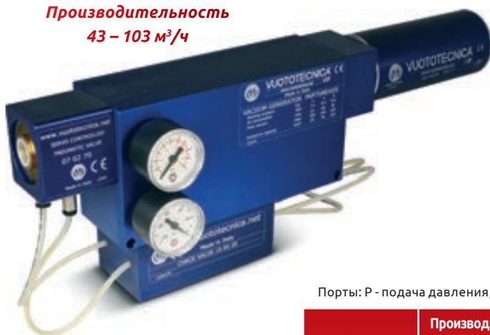
Многостадийные генераторы вакуума серии PVP 25÷75 MDX ES являются энергонезависимыми автоматическими устройствами, способными поддерживать уровень вакуума на определенном значении (при помощи пневматического реле давления) и при этом не требующие электрического напряжения питания. При достижении требуемого значения вакуума генератор не потребляет сжатый воздух благодаря встроеному пневмоклапану.
